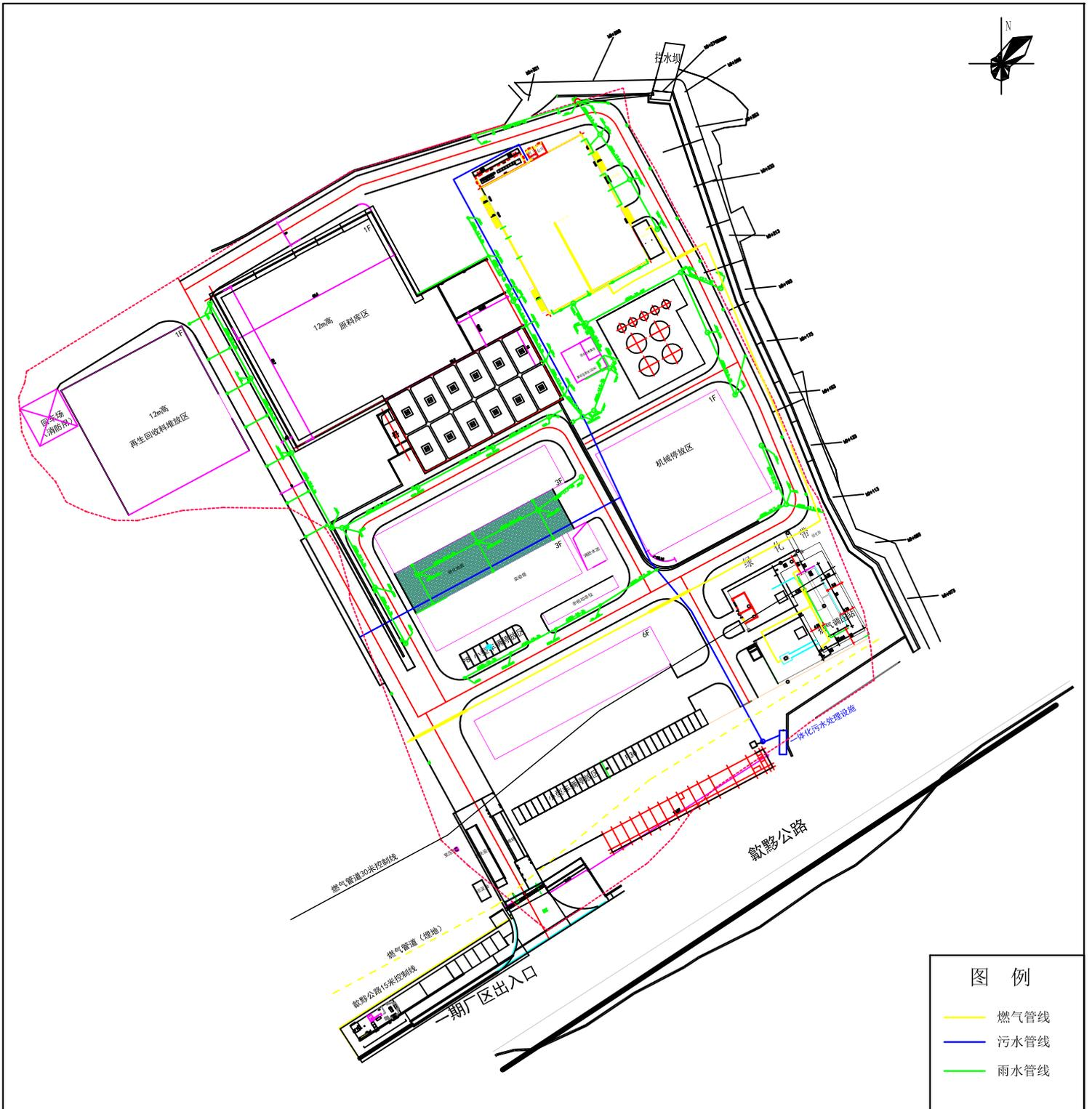
附图5 厂区雨污管网示意图
